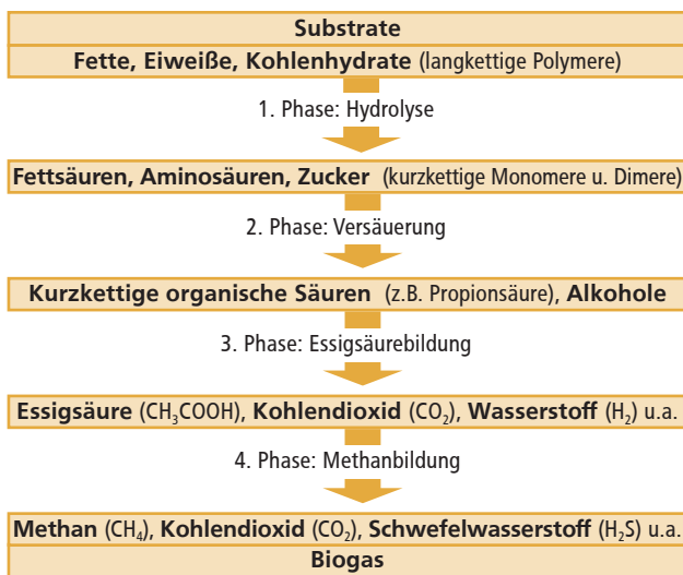
Vereinfachte Darstellung des Abbaus organischer Substanz bei der Biogasgewinnung. Quelle: Fachagentur Nachwachsende Rohstoffe e.V. (FNR), www.fnr.de
