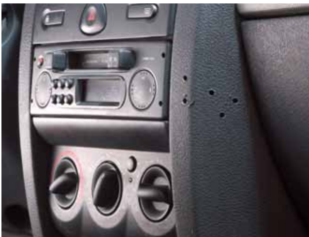
Abb. 3: Innenraum mit Bohrlöchern
